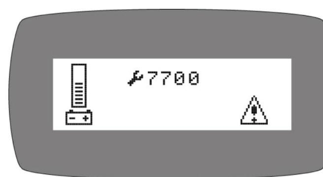
3. Ошибки **7700**, **7701**, **7702** и **7703**: Вакуумный мотор превысил пределы допустимой мощности. Выключите зажигание и включите машину заново.
