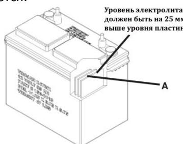
2. Для предотвращения коррозии протрите верхнюю часть аккумулятора.
