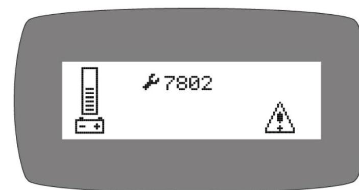
8. Ошибка **7802**: Тяговый двигатель превысил допустимый предел мощности, возможно из-за подъема по наклонной поверхности более 60 секунд. Выключите зажигание, затем заново включите и продолжайте. Не следует пользоваться машиной на круtyх подъемах или слишком длинных наклонных поверхностях, в противном случае данная ошибка будет показываться несколько раз, в результате чего будет перегрев двигателя.
