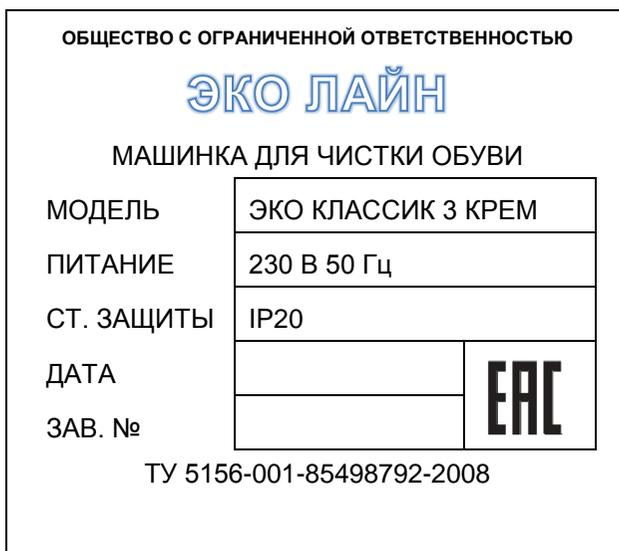
Рисунок 2 – Пример маркировочной таблички
